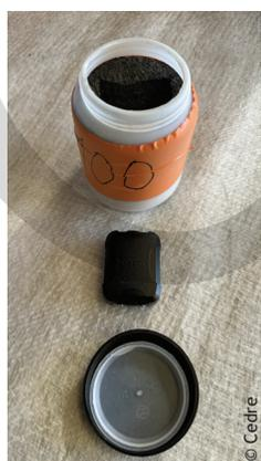
Figure 26 : Principaux éléments constitutifs des bouées SPOT (Récipient étanche, traceur GPS, lest)
