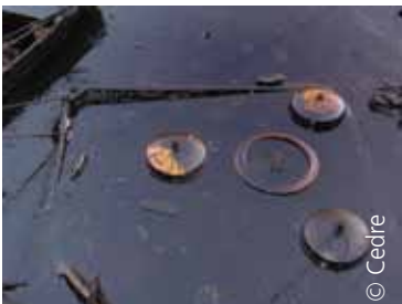
Les déchets solides flottants peuvent venir colmater les récupérateurs et nuire à leur fonctionnement
