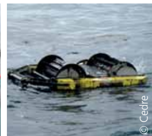
Mise en œuvre de récupérateur sans confinement, peu efficace et rapidement arrêtée
