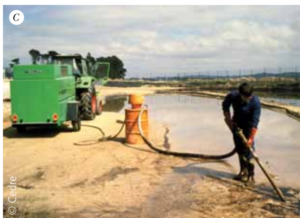
Tonnes à vide agricoles (A) Aspirateur portatif (B) Aspirateur portable (C)
