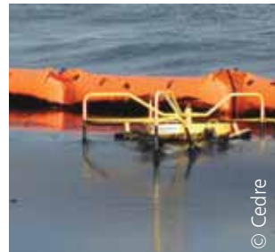
Optimisation de l'emploi d'un récupérateur par la mise en œuvre d'un barrage de confinement
