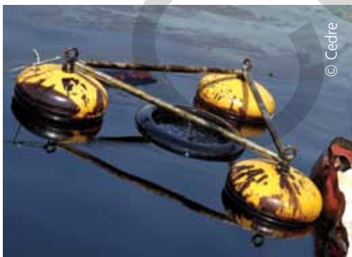
Récupérateur mécanique (à déversoir)
