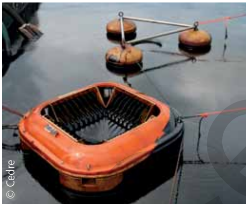
Comparaison de l'efficacité de récupérateurs mécanique et oléophile
