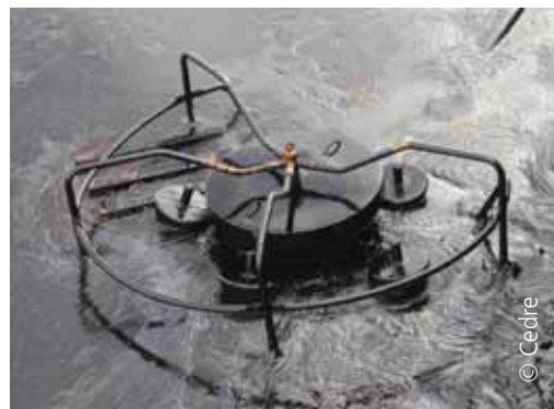
Récupération de fioul lourd visqueux
