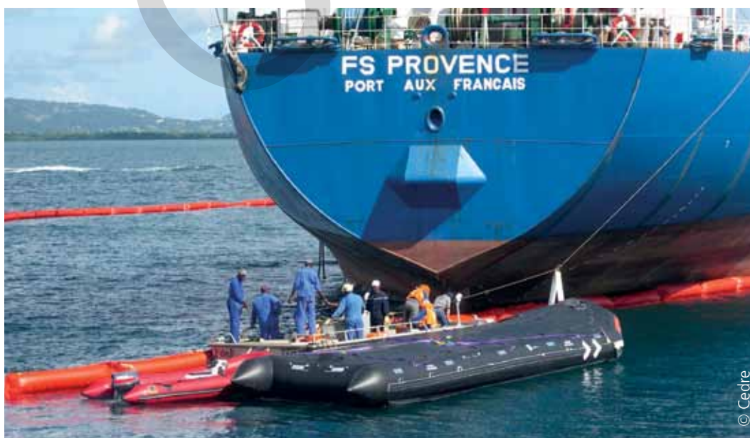
Exercice de mise en œuvre de moyens de confinement-récupération et de stockage flottant
