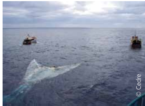
Mise en œuvre de chalut antipollution par des bateaux de pêche
