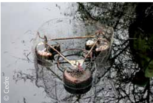
Dispositif d'arrêt des macrodéchets, Ambès (2007)
