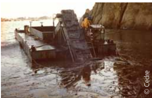
Récupération de polluant sur l'eau devant un site peu accessible
