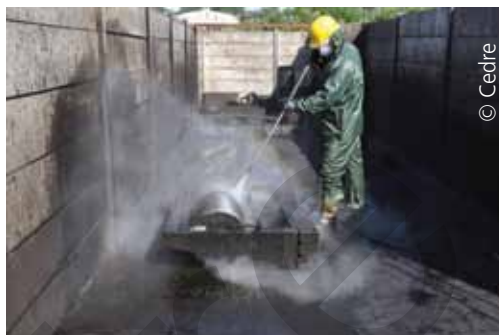
Nettoyage de récupérateur sur une aire adaptée
