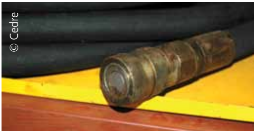
Raccord de flexibles hydrauliques
