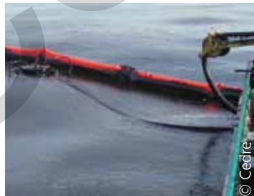
Optimisation de l'emploi d'un récupérateur par la mise en œuvre d'un barrage de confinement
