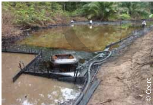
Récupérateur à disques en présence de débris flottants
