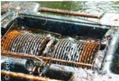
Récupération peu sélective du fait de la vitesse trop élevée des brosses
