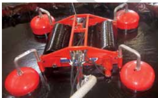
Essais de récupérateurs au centre d'essai de NCA à Horten
