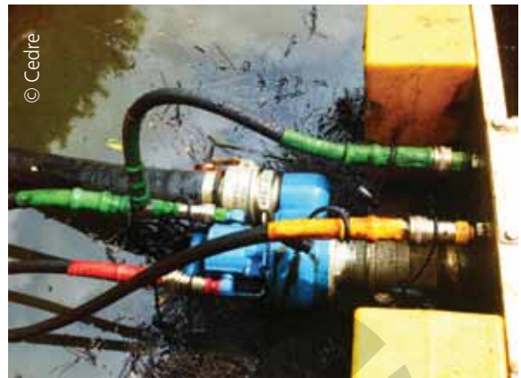
Raccords de flexibles hydrauliques et de transfert
