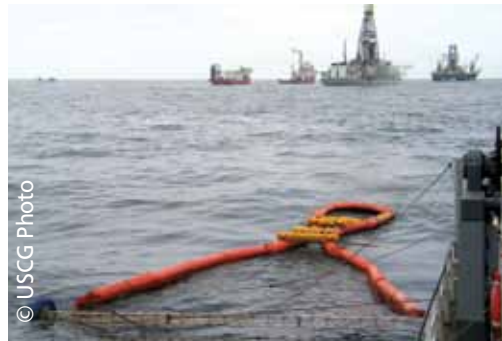
Dispositif concentrateur permettant des vitesses de collecte supérieures
