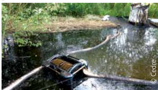
Récupérateur à brosses en présence de débris flottants
