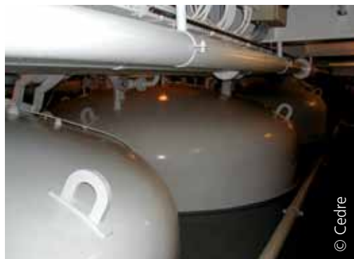
Cuves de stockage à bord d'un navire récupérateur
