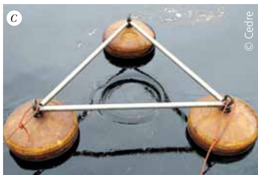
Barge récupératrice autopropulsée (A) Récupérateur dynamique (à couple de navire) (B) Récupérateur statique (C)
