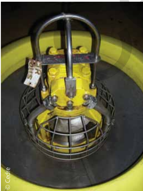
Pompe de transfert intégrée dans un récupérateur à seuil
