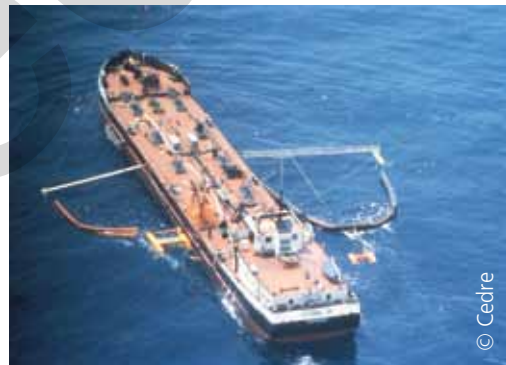
Pétrolier caboteur prééquipé pour le déploiement de récupérateurs à couple
