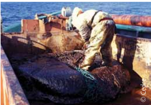
Chalut englué de pétrole stocké dans une cuve sur le pont d'un navire
