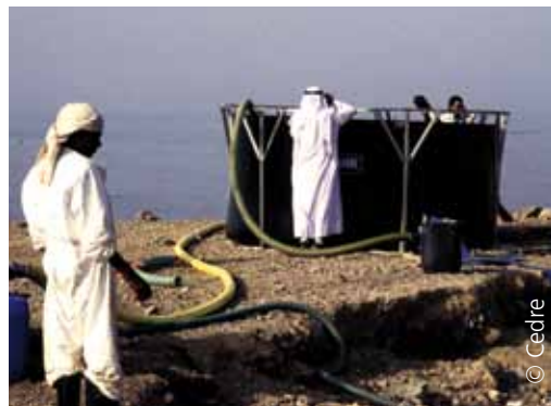
Stockage souple à armature
