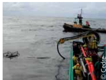
Mise en œuvre de récupérateur sans confinement, peu efficace et rapidement arrêtée
