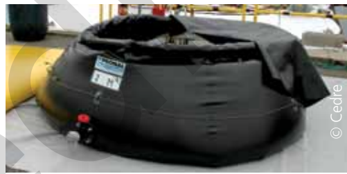
Réservoir souple de stockage muni d'une purge permettant d'évacuer l'eau décantée
