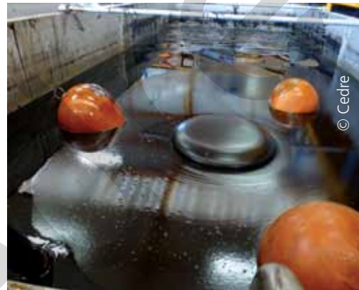
Évaluation d'un récupérateur mécanique à seuil auto-ajustable
