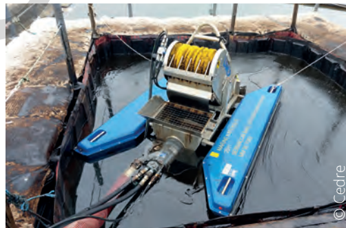
Récupérateur et pompe intégrée lors d'essais réalisés au Cedre
