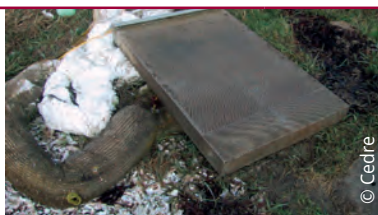
Cartouche filtrante (structure grillagée)
