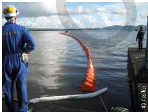
Formation au déploiement de barrage\*
