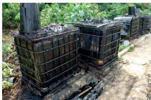
Système improvisé de séchage/égouttage : débris végétaux posés sur un grillage lui-même posé sur un GRV
