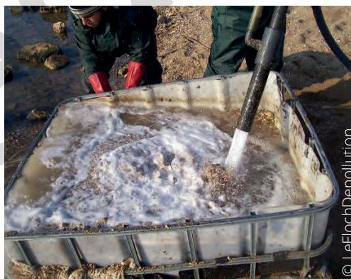
*Système de fortune de séparation de sédiments/hydrocarbures par flushing*
