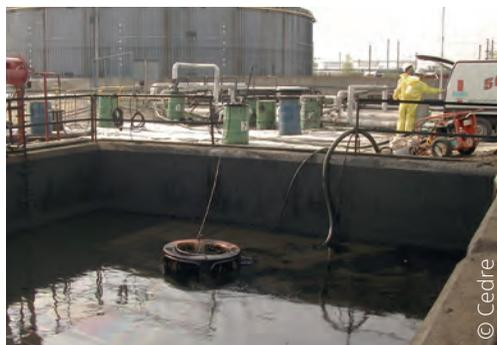
Opérations de prétraitement réalisées sur le site de l'industriel : décantation/séparation des hydrocarbures et de l'eau collectés dans l'estuaire pour recyclage des hydrocarbures
