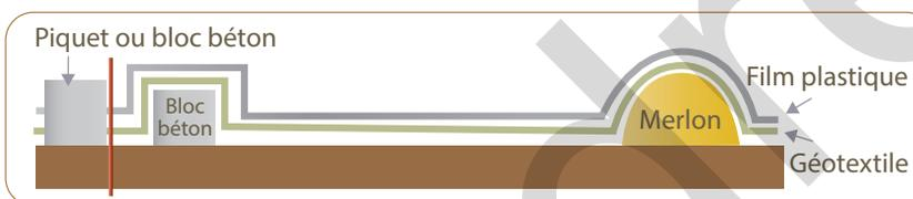
Figure 10 : schéma de principe d'une plateforme étanchéifiée pour les déchets en vrac (vue en coupe)
