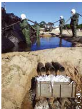
Dispositif de filtration garni d'absorbants en spaghettis
