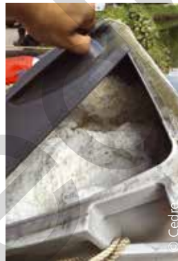
Absorbants souillés après passage d'effluents pollués dans un dispositif filtrant de type poubelle percée
