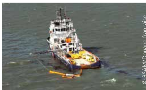
Chalut de surface garni d'absorbants pour piégeage au fil de l'eau
