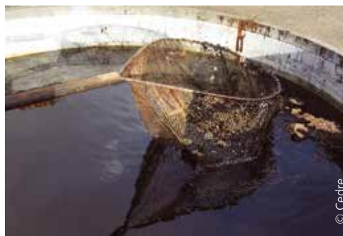
Récupération des absorbants à l'aide d'une épuisette
