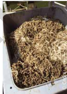
Absorbants souillés après passage d'effluents pollués dans un dispositif filtrant de type poubelle percée
