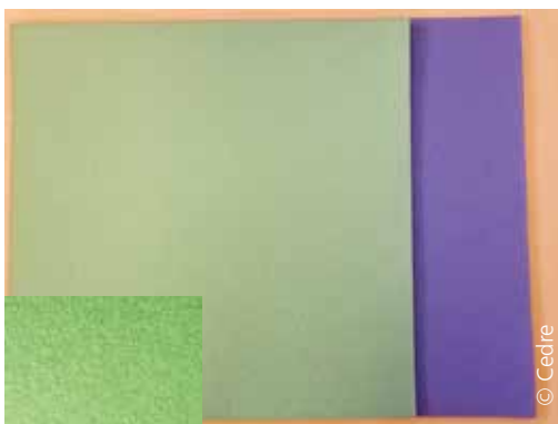
Feuilles d'absorbants à cellules ouvertes réutilisables
