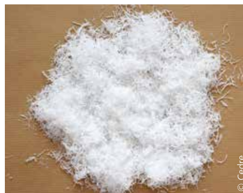
Polyméthacrylimide issu de fragments d'ailes d'avions
