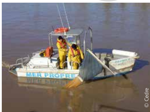
Petit navire récupérateur avec son filet garni d'absorbant
