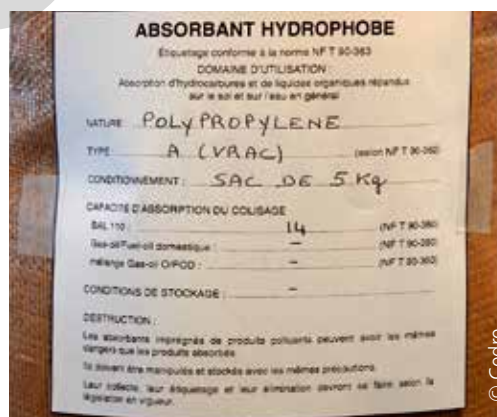
Étiquetage des absorbants flottants
