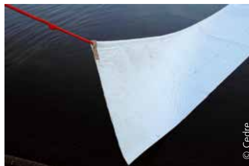
Rouleau absorbant équipé d'un filin (ou ralingue)
